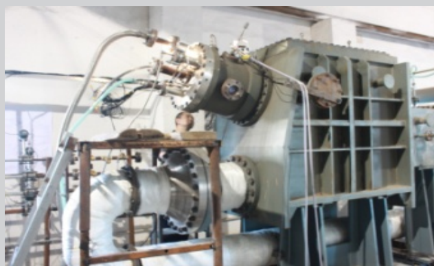
5兆瓦级低污染航改燃气轮机
